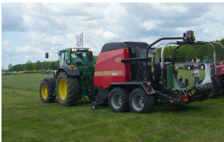
Rys. 3. Ciągnika zasilany czystym olejem roślinnym przy pracy (zdjęcie autora)
